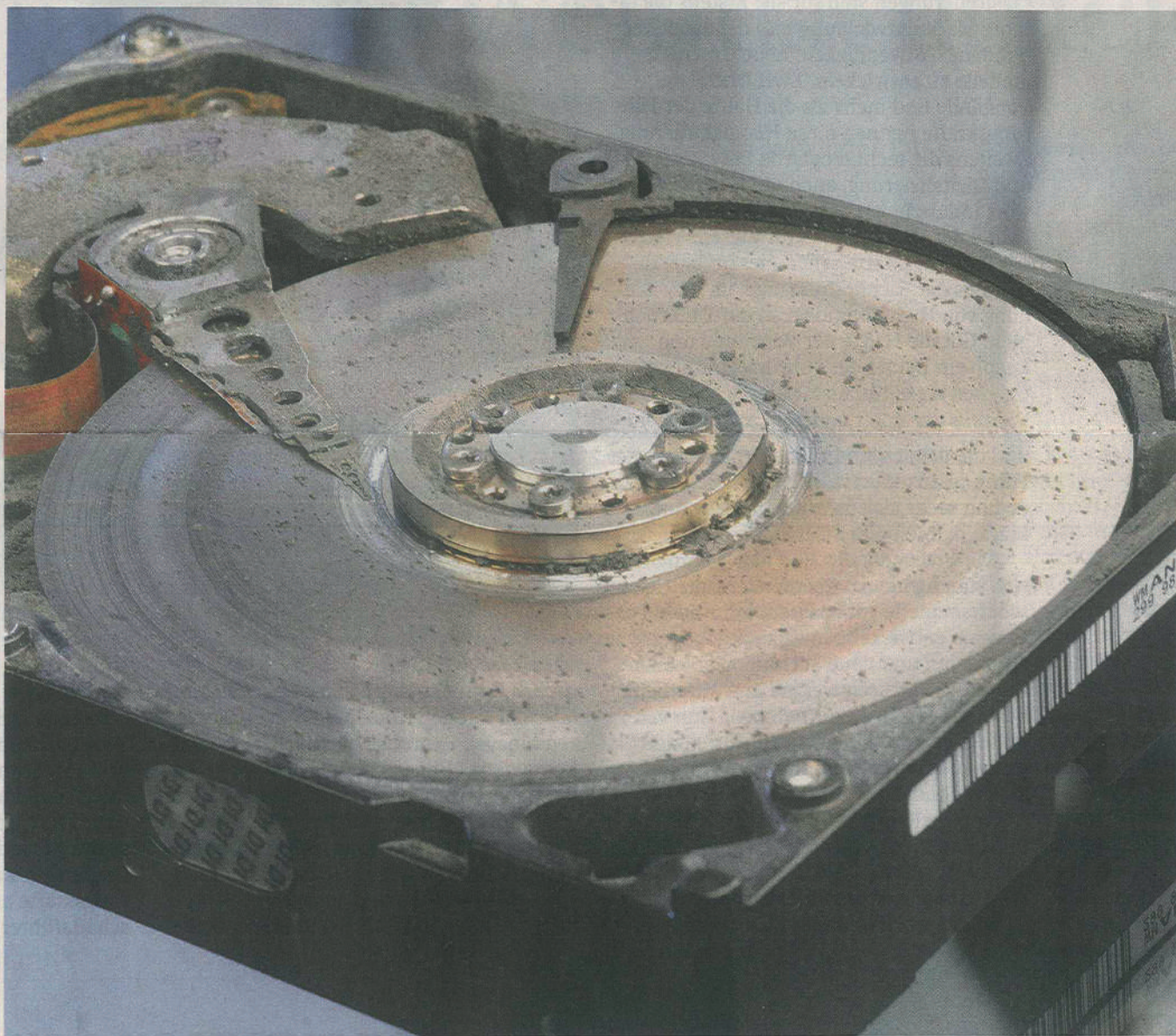
Ein „Heimwerker“ versuchte selbst, Daten zu retten und vernichtet dabei gleich die Magnetschicht.
