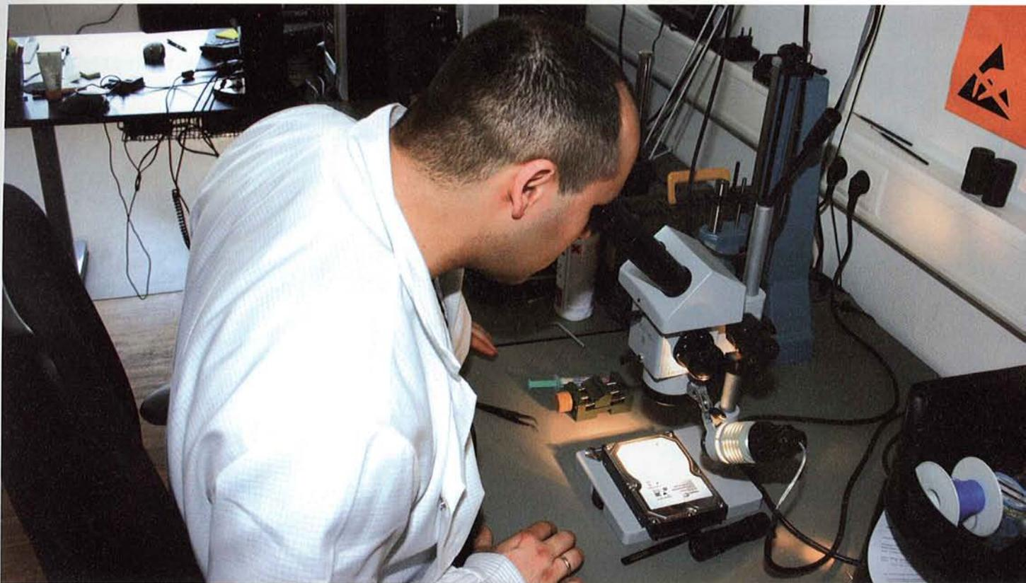
Ähnliches Prinzip wie bei einer Schallplatte: In der Werkstatt werden Festplatten zunächst auf feinste Beschädigungen wie Kratzer untersucht
